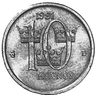
Fig. 1. Äkta 10 kr 1991. Föreskriven vikt 6,60g; legering av 89 % koppar, 5% aluminium, 5% zink, 1% tenn.
