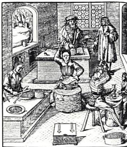
2. En myntpräglingsverkstad omkring 1500 med traditionell tillverkning för hand. Träsnitt av Hans Burgkmair, ur ett större verk avsett som undervisning för den unge kejsar Maximilian. Detta verk, som först långt senare blev utgivet av trycket, kallas "Den vite konungen". Längst upp i rummet syns myntmästaren vid sitt bord, undervisande den unge kejsaren. Tv smältes metallen i deglar. Nedtill t v sitter en man som klipper till myntämnena; i mitten hamras myntplåten, längst t h sker själva präglingen.
